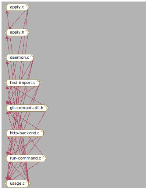
Abbildung 6. Dateien, deren Funktionen von Funktionen aus „usage.c“ aufgerufen werden mit ihren Aufrufen untereinander.
